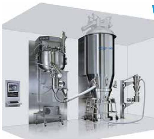
Equipos para mezcla, granulación y secado por lecho fluido. Sistema para recubrimiento de tabletas y gránulos, sistemas compactadores de polvos por rodillos, mezclador-granulador Alto Cizallamiento
